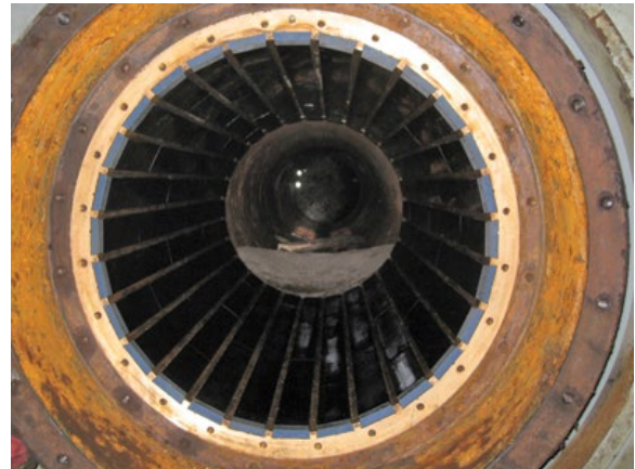
Sistema ROMOR® I de carcasa de cola de milano de bronce naval.
