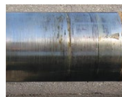
Rayaduras de los ejes causadas por las empaquetaduras de lino
