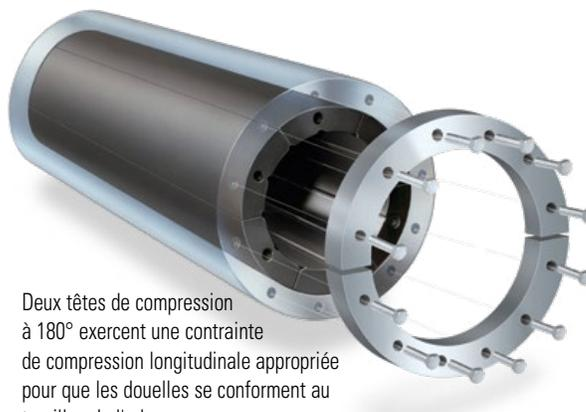
Deux têtes de compression à 180° exercent une contrainte de compression longitudinale appropriée pour que les douelles se conforment au tourillon de l'arbre.
